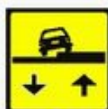
Denivelare față de banda alăturată
