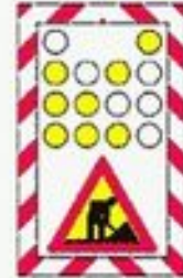
Semnalizarea unui utilaj care se deplasează lucrând
