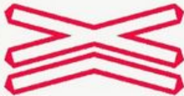
Trecere la nivel cu o cale ferată dublă, fără bariere
